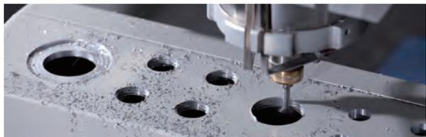
タカチではマシニングセンタにより、螺旋状のタップ加工を致します。
